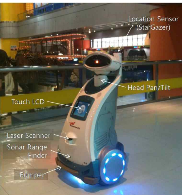
그림 3. 안내로봇 II의 하드웨어 구성. Fig. 3. Hardware elements of the tour-guide robot II.
