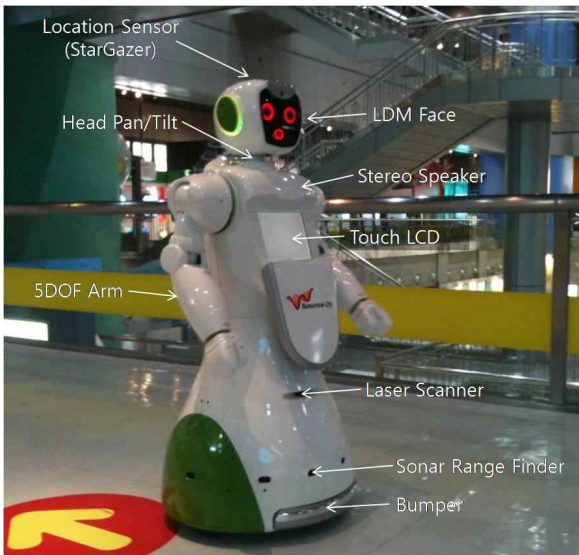
그림 2. 안내로봇 I의 하드웨어 구성. Fig. 2. Hardware elements of the tour-guide robot I.
