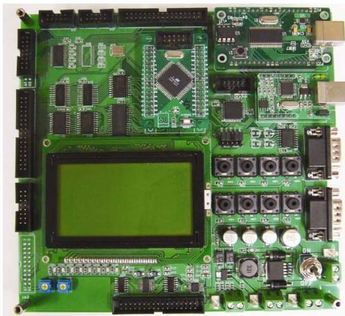
그림 3. ATMEGA128기반의 자체 개발된 DAQ 장치.
