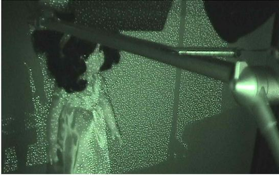
(그림 1) Kinect에서 방출된 near IR 점 패턴의 투사 모습
