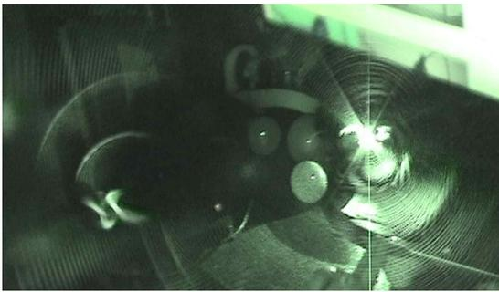
(그림 2) Kinect IR 출력부에서 방출되는 IR
