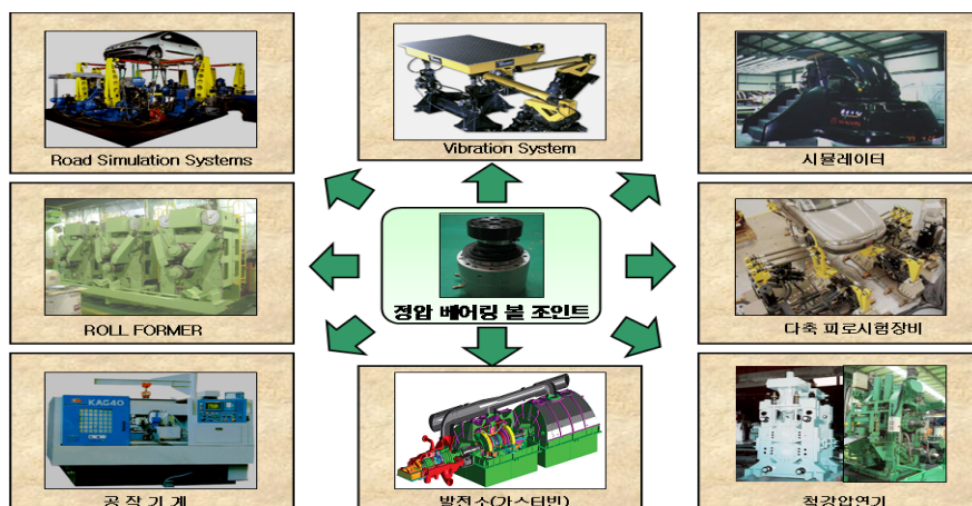
<그림 1> 정압 베어링 볼 조인트의 응용분야
