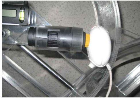
그림 6. 단안망원경(7×18 mm)에 ToUcam을 연결한 모습
