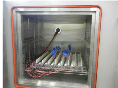
<그림 6> 고온부하 시험 장면
