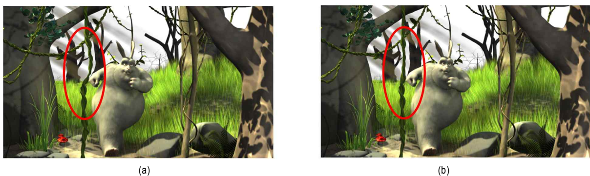
그림 9. 생성된 가상시점 영상에서 발생한 직선 왜곡 및 이의 직선 성분 제약 조건에 의한 보정 결과의 예 (a) 가상시점 영상에 발생한 직선 왜곡의 예 (b) 제한한 직선 성분 제약 조건 적용 결과(빨간색 타원 부분 비교) Fig. 9. (a) An Example of Line Distortion in the generated virtual-view image (b) Application Result of line segment constraint (red eclipse part)
