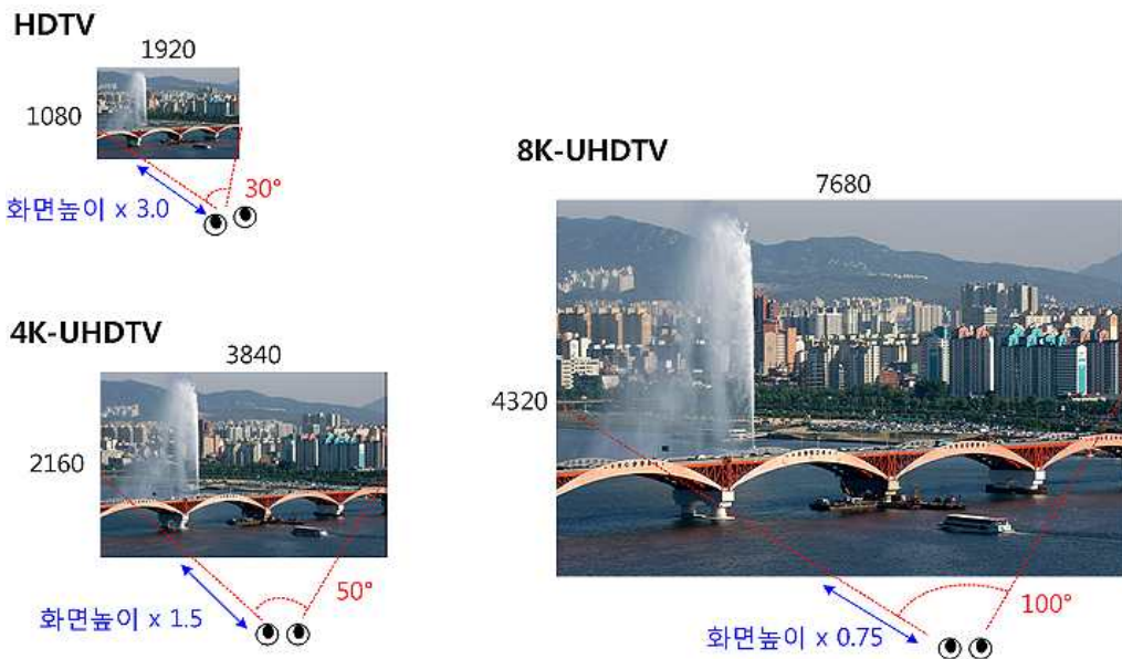
그림 1. HDTV와 UHDTV의 비디오 해상도 및 적정 시청거리[1] Fig. 1. The video resolution and reasonable viewing distance for HDTV and UHDTV
