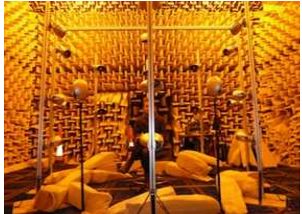
그림 9. 무향실에서 주관적 음질 평가 Fig. 9. The subjective test at anechoic chamber
