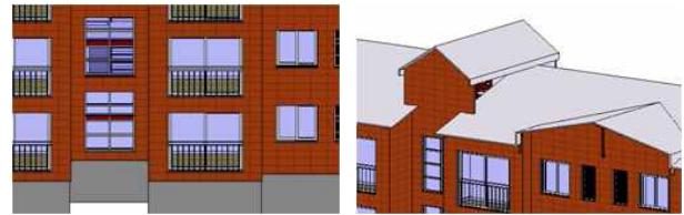
a) 계단실 창호깊이 오류 b) 지붕선 간섭 그림 18. 간섭검토 결과
