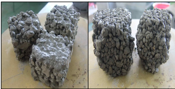
a) 표면마함 발생 공시체 b) 깨짐현상 발생 공시체 그림 2. 표면마함이 발생한 공시체와 깨짐 현상이 발생한 공시체
