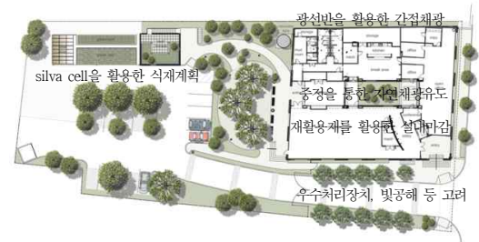
그림 2. TAK Center의 site plan
