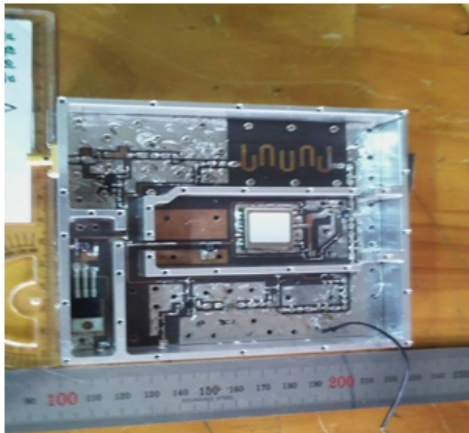
그림 3. 제작된 라디오미터 수신기 Fig. 3. Photograph of the fabricated receiver.
