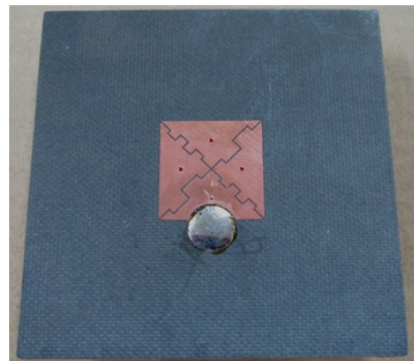
그림 12. 제작된 안테나 Fig. 12. Fabricated antenna.
