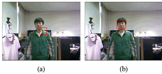
그림 10. 오검출의 예; (a) Viola와 Jones의 방법, (b) 제안한 얼굴검출 방법 Fig. 10 Example of negative-true detection; (a) Viola and Jones method, (b) proposed face detection method
