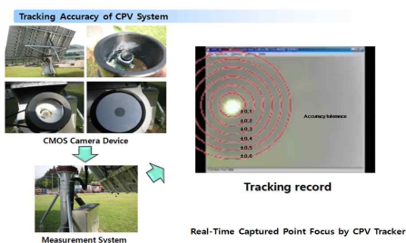
그림 6. 추적센서의 성능 실험 Fig. 6. Performance Test of Solar Tracker Sensor
