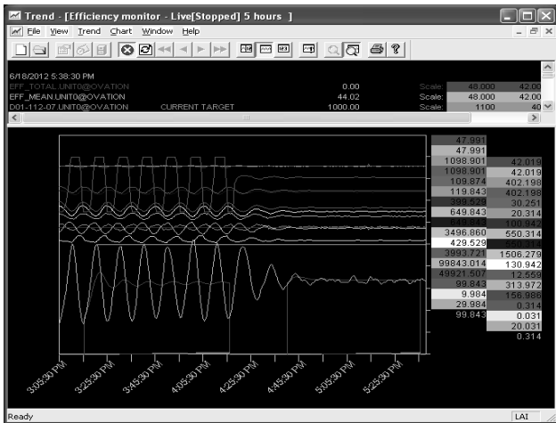
그림 8 증기 온도 불안정/안정상태 효율(적색: 43.95 → 44.03%) Fig. 8 Reheat steam temperature control and efficiency
