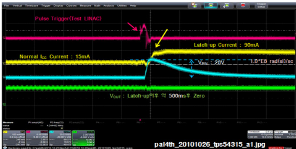
그림 12 단일펄스방사선 조사조건에서의 TPS54315소자의 펄스방사선 시험결과(Latchup), Fig. 12 Irradiation test result of TPS54315 for single pulsed radiation, (Latchup)
