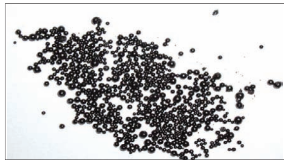
그림 3. 제강슬래그를 골재로 재활용한 PS ball 형상
