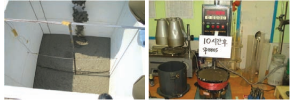
사진 3. 분리타설 Mock-up 시험, 응결시간 측정
