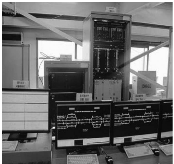
그림 3. 지상 인터페이스 장치 및 시뮬레이터
