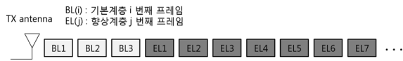
그림 9. 종래 기술에 따른 각 계층 데이터 전송 형태 Fig. 9. conventional data transfer form of each layer
