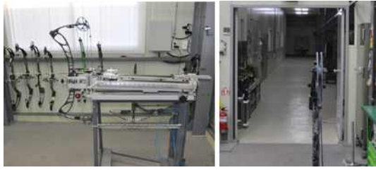
그림 10. 화살 발사대 및 슈팅 거리 Fig. 10. Arrow's Launcher and Shooting Distance
