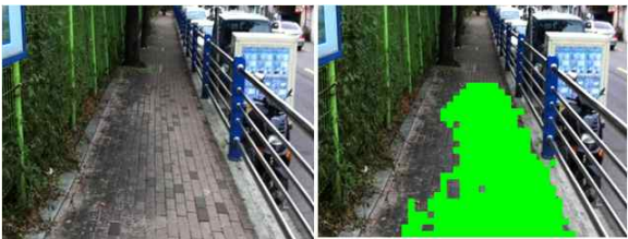
(c) 보도의 변색으로 인한 오검출 결과 (c) Faded road
