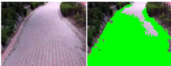
(a) 조명으로 인한 오검출 결과 (a) Changed light
