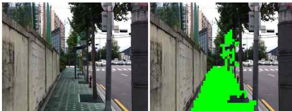
(b) 주변 잡음으로 인한 오검출 결과 (b) Various noises(road side trees, electric poles, etc.)
