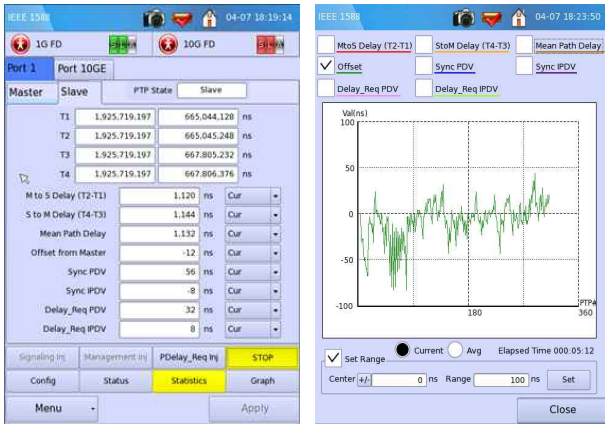
그림 8. Slave의 통계 및 그래프 화면 Fig. 8. Statistics and Graph screen of Slave
