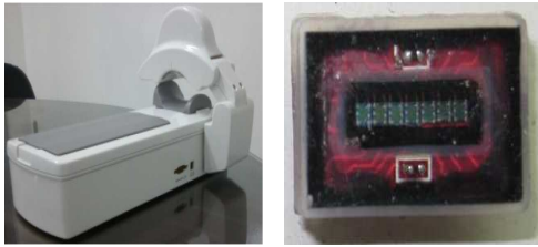
그림 1. (a) 맥파 측정 기기 (Mac-01, HuBDIC, Korea), (b) 7개의 압력센서로 구성된 센서 모듈 Fig. 1. (a) Pulse-taking device (Mac-01, HuBDIC, Korea), (b) Sensor module consisting of seven pressure sensors 7개의 센서에서 측정된 맥파를 나타낸다. 7개의 그래프 중에서 각 단계별로 파형의 형태가 온전하고 단계가 증가할수록 크기가 증가하는 그래프 하나를 선택하였다. 대체적으로 4번째 센서에서 측정된 데이터 파형이 신호 대 잡음비가 가장 좋았다. 그림 1. (b)의 센서모듈에서 4번째 센서는 7개 중 가운데에 있는 압력센서를 가리킨다. 선택한 그래프를 5개의 가압 단계로 나눈 후 각 단계 파형들의 시작점을 일치시키기 위하여 저역통과 필터 처리를 하였다. 필터 처리를 한 후 각 단계별로 5개의 한 주기 파형들을 추출하였다.
