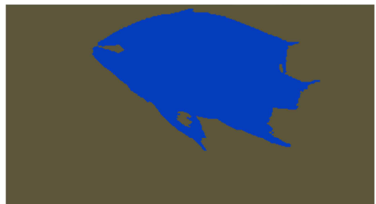
그림 8. 후처리 결과. 너무 작은 사이즈를 가진 영역들은 이 주변의 큰 영역에 포함시킨다. 너무 작은 사이즈의 영역은 일종의 노이즈로 간주한다.
