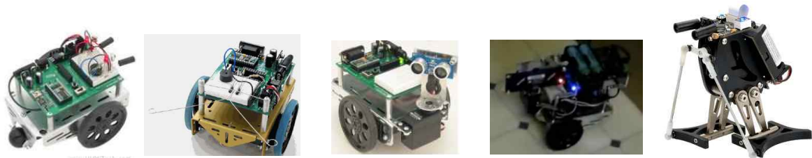
그림 5. 실험을 위해 구현한 IR, 더듬이, 초음파, 레이저 센서를 부착한 보트로봇, IR을 부착한 펭귄 로봇
