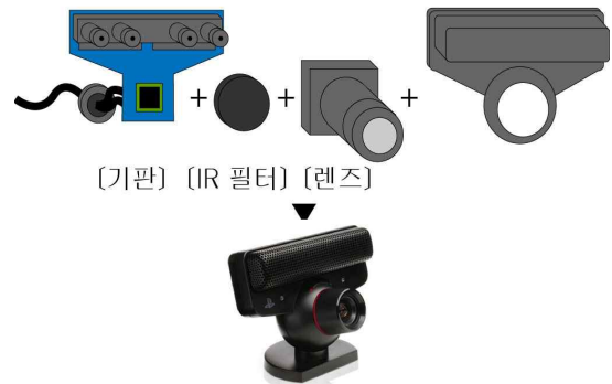
그림 11. 적외선 (IR) 카메라 구조
