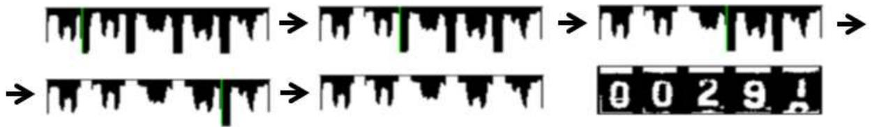
그림 4. 불필요한 분리지대 패턴 제거 과정 및 최종 처리 결과 이진 이미지
