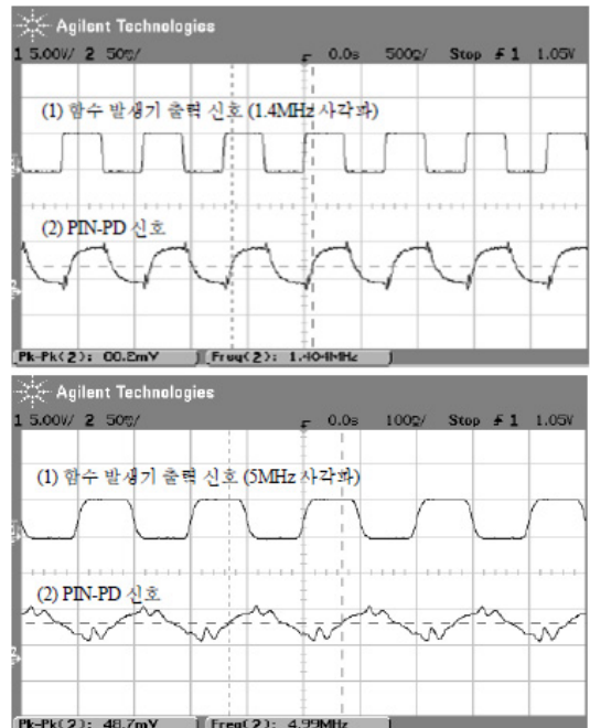
그림 2. 구형파 (1.4MHz), (5MHz) 송수신신호 Fig. 2. Squarewaveform (1.4MHz), (5MHz)
