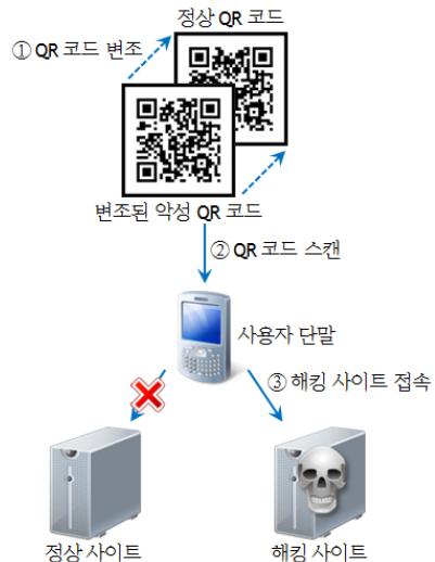
그림 5. QR 코드 변조를 이용한 공격 Fig. 5. Attack by modification of the QR code
