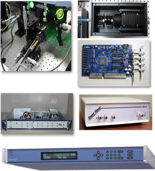
그림 13. OES 주요 장치, 좌 상단부터 시계방향으로, SPD, C-SPAD, 광전자 제어기, Event Timer, Xli GPS 기준 시간장치, 그리고 PDU.
