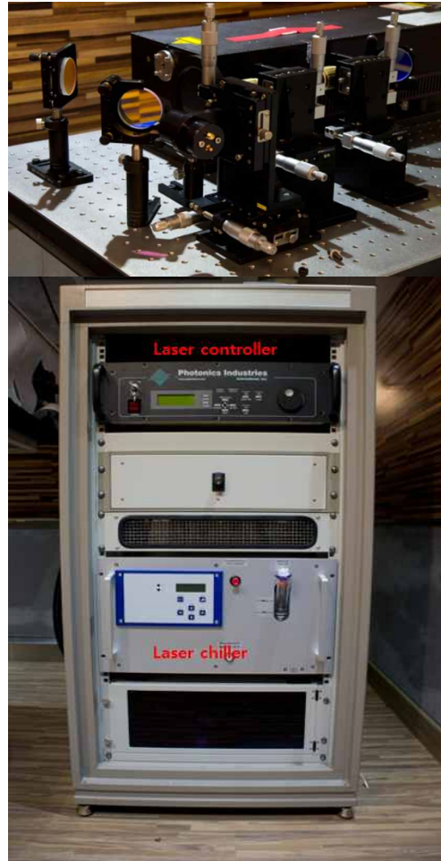
그림 8. PI사의 RGL-532 레이저 시스템. 레이저 발진기(상), 레이저 컨트롤러와 냉각장치(하). ARGO-M CDS 내 레이저실에 장착됨.
