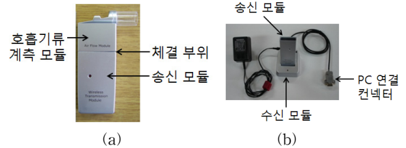
그림 16 무선 송수신 모듈의 실물사진 Fig. 16 The wireless receiver and transmitter modules
