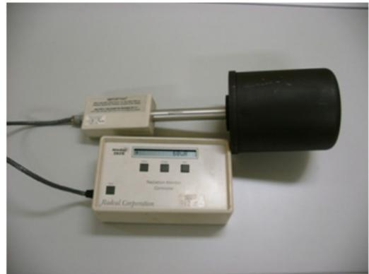
그림 1. Ionization Chamber and Electrometer
