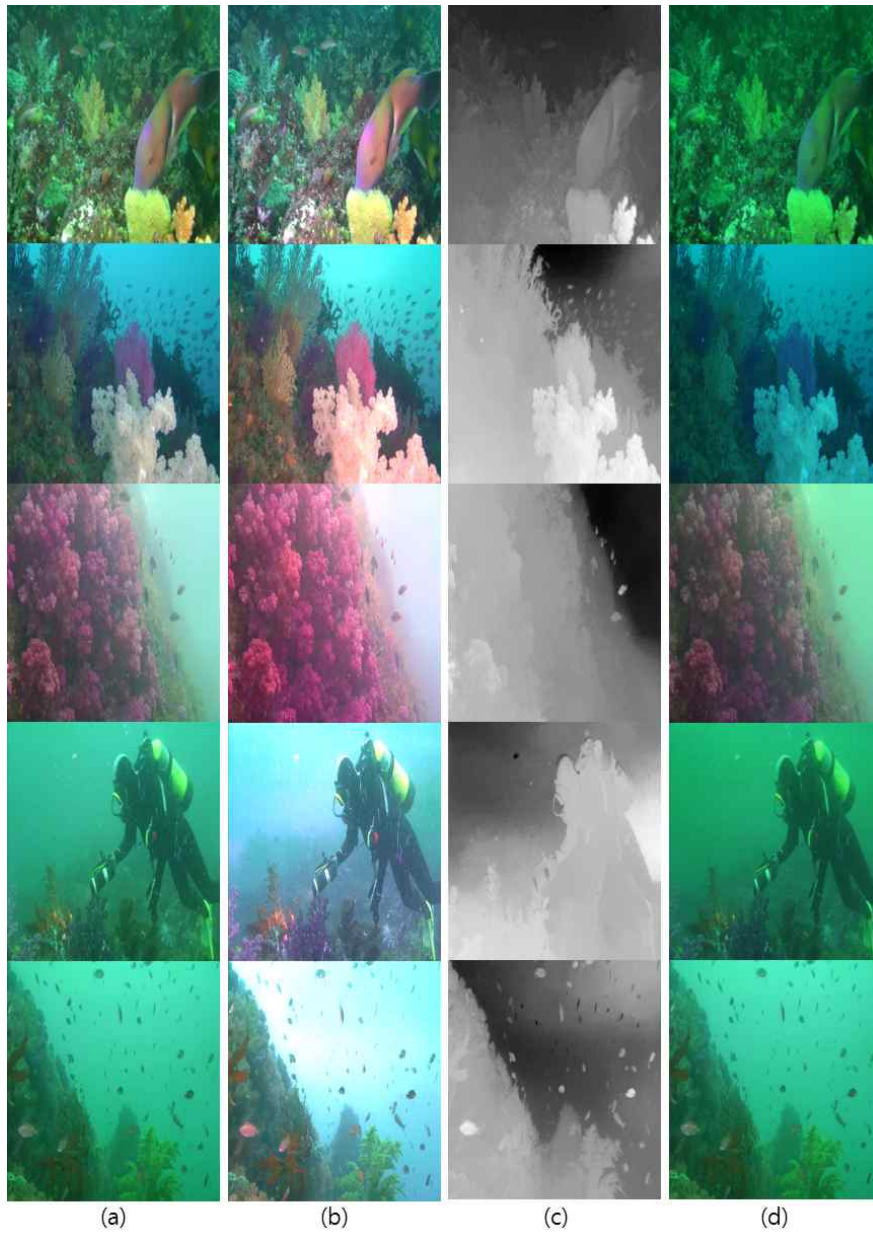
그림 9. 다양한 수중 스테레오 영상에 대한 제안 방법을 이용한 가시성 개선 결과, (a) 원본 스테레오 영상(좌 영상), (b) 가시성 개선 영상, (c) 제안하는 방법으로 계산한 전달률, (d) 제안하는 방법으로 예측한 산란광에 의한 열화값
