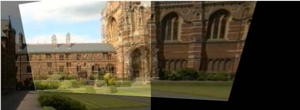
그림 4. 선형해법으로 정합한 영상. 어긋난 부분을 볼 수 있다. Fig 4. Image stitched by linear method
