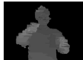
그림 22. 평균필터 적용된 깊이 영상 Fig. 22. Depth Image Applied Mean Filter
