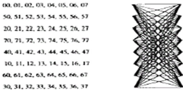
그림 3. 8-PSK, 8-states, 3 bit/s/Hz Fig. 3. 8-PSK, 8-states, 3bit/s/Hz
