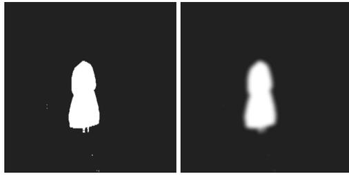
그림 7. Gaussian Filter를 적용한 Smooth the depth image
