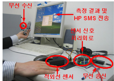
그림 1. 맥박측정시스템 구성 Fig. 1 Pulse measurement system configuration
