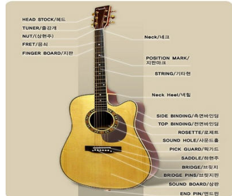
그림 2. 어쿠스틱 기타(통기타)의 구조 Fig. 2 Structure of acoustic guitar
