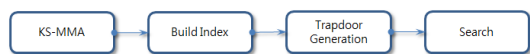
그림 5. 검색 가능 이미지 암호 시스템의 기본 구성 Fig. 5 Basic structure of searchable image encryption system
