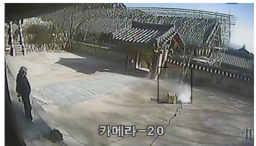
그림 4. 야외에서 연기검출 실험 결과 Fig. 4 Experimental result of smoke detection at the outdoor
