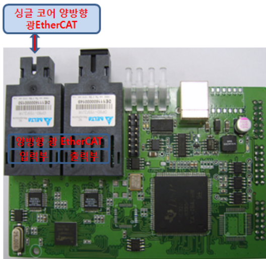
그림 2. WDM 방식을 적용한 싱글 광 코어 기반의 양방향 광 이더넷 통신 모듈
