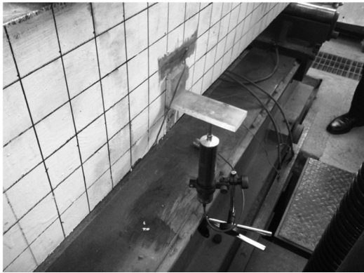
Fig. 4. Setup of lvdt.
