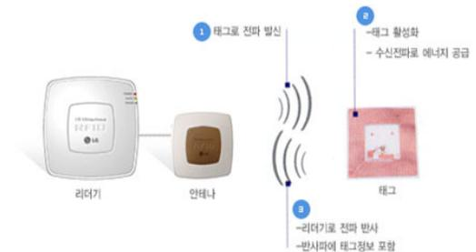
그림 3. RFID 구성 원리
