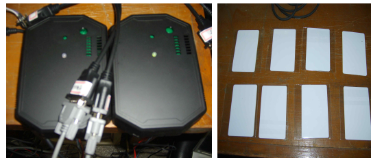
그림 6. 교통사고조사용 RFID TAG 및 READER기
