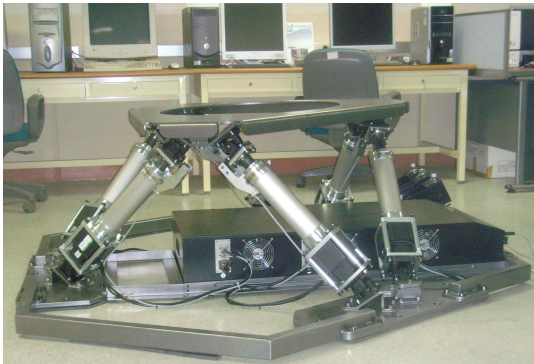
그림 2. Structure of 6 D. O. F Motion Base
