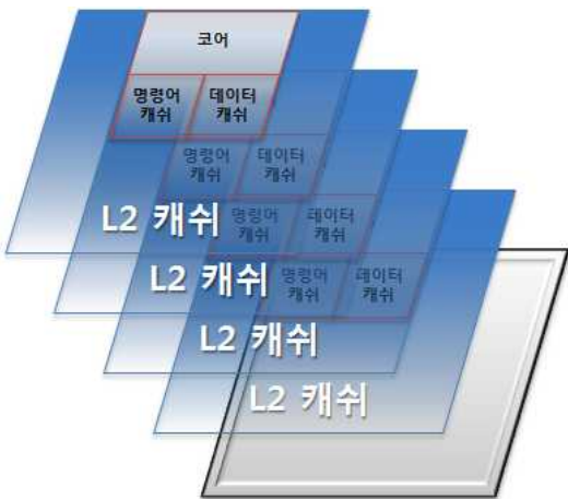
그림 1. 3차원 쿼드코어 프로세서 구조 Figure 1. Architecture of 3D Quad-core processor
