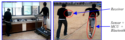
그림 4. 보행 및 주행 실내/실외 테스트 Fig. 4 The indoor/outdoor test in walking and driving
